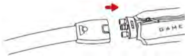
7 커넥터 호스를 사용하여 랩을 제어 장치에 연결하십시오. "찰칵" 소리가 들릴 것입니다. 연결을 해제하기 위해서는, 단순히 청색 또는 회색 버튼을 누른 후에 커넥터를 랩에서 분리하십시오.
