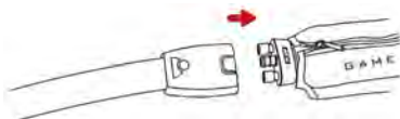
7 Bevestig de zwachtel aan het regelapparaat met behulp van de verbindingsslang. U dient een klik te horen. Om de slang los te koppelen drukt u eenvoudigweg op de blauwe of grijze knop en maakt u het aansluitstuk los van de zwachtel.
